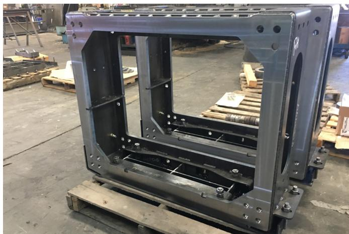
Все поверхности рабочего органа были тщательно обработаны, секции каркасного типа достаточно прочны и гарантируют достижения отличной ровности на участках с повышенными требованиями к ней. Возможно исполнение с одной или несколькими двускатными секциями. Мощные фланцы уменьшают количество крепёжных болтов на секцию и способствуют ускорению смены рабочей ширины. Рабочий орган может быть быстро и легко смонтирован в разных местах под трактором S850 и также быстро демонтирован.
