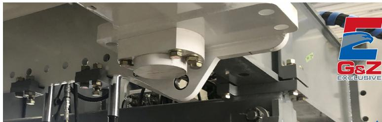
Гидрозажимы вместо механических чтобы легко и быстро менять рабочую ширину двойной раздвижной рамы трактора.
