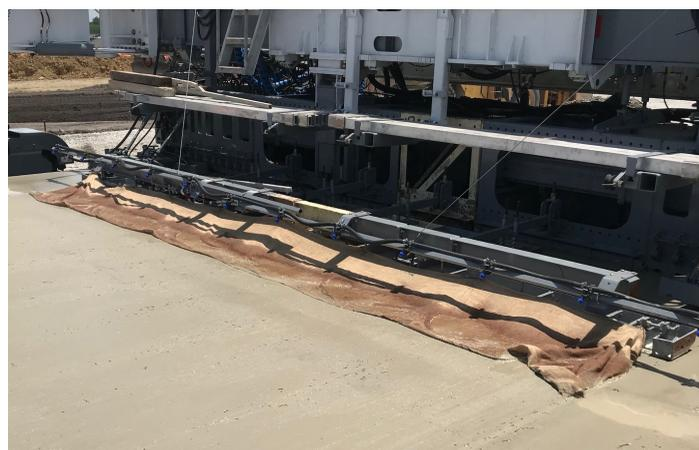
Для улучшения ровности S850 может оборудоваться выглаживающей плитой TFP. Она имеет ширину 1,2м и со своими фиксированными концевыми сегментами обеспечивает благодаря точной настройке острые кромки плиты. Плита TFP адаптирована под широкий спектр боковых забивщиков анкеров.
