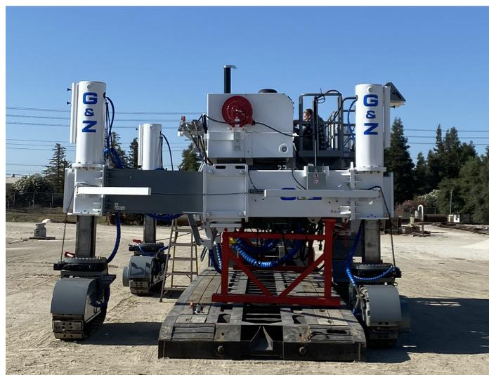
С системой QUADRA существует два режима транспортировки: сжатый для заезда (с или без рабочего органа) на низкорамный прицеп шириной 3.04м со съёмным гуськом или расширенный для раздвижки опор и самопогрузки на ступенчатый трейлер шириной 2.5м. В сжатом режиме габарит составляет 3.65м с рабочим органом и откинутой выглаживающей плитой. Длина груза составляет 3.35м плюс ширина укладки, что значительно меньше длины укладчика в исполнении с поворотными опорами.
