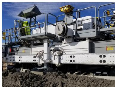
Менять рабочую ширину плуга быстрее и проще чем шнека. Секции направляющих ходовой тележки не нуждаются в промежуточных держателях. Всего четыре болта на стыке быстро и легко открутить при смене рабочей ширины.
