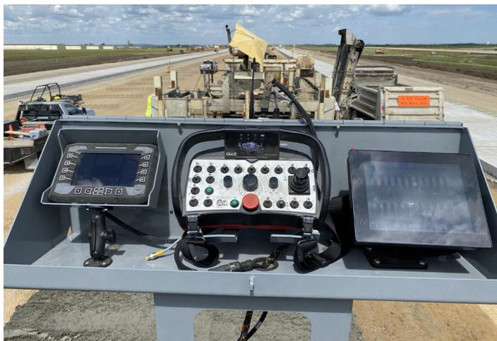
Консоль системы EGON Belly Pack даёт оператору полную свободу действий. Belly Pack состоит из перемещаемой докстанции.
