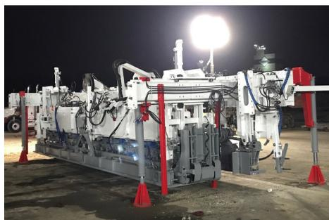
Используя дополнительные стойки для самопогрузки DBI, модульный DBI может самогрузиться без помощи крана, экономя время и деньги.
