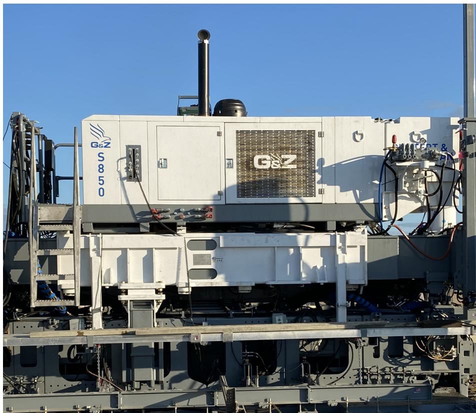
Сердцем двигательного отсека является новый, тихий, малоэмиссионный дизельный двигатель с отличным доступом ко всем фильтрам и насосам. Вентилятор радиатора двигателя с гидроприводом и регулируемой скоростью, теплообменник, двойная виброизоляция и шумозащитный кожух гарантируют оператору высокий комфорт. Дизельный бак (с баком DEF) легко доступен за СУ с платформы оператора. Электро- и гидрофильтрационные системы СУ были усовершенствованы для упрощения доступа, мониторинга и диагностики.
