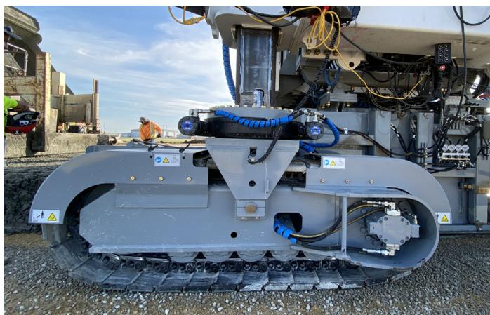
Система AccuSteer, используя червячные редукторы с поворотом на 320° и гидроприводом, обеспечивает хорошую манёвренность и синхронность при движении с поворотом на 90° в любом положении консольных опор.
