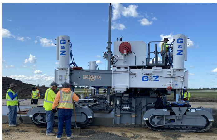
Телескопируемые консольные опоры QUADRA свойствен только укладчикам G&Z. У них есть два режима укладки: расширенный для обычной укладки или сжатый при нехватке места или малых радиусах. В сжатом режиме машина работает как двухгусеничная. Для перевозки опорные ноги из расширенного режима сдвигаются с помощью гидравлики.
