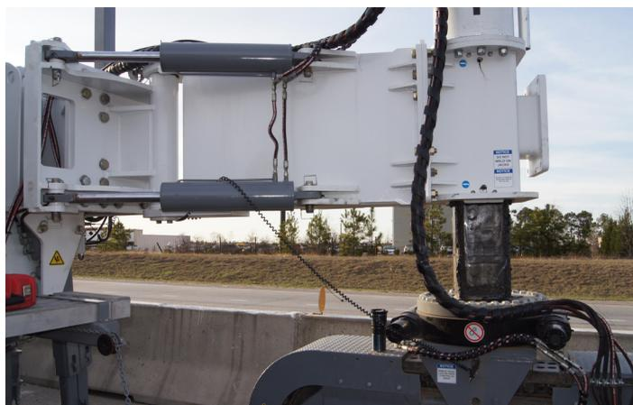
Системы SmartLeg и AccuSteer, работая вместе, быстро меняют угол поворота консольных опор для обхода препятствий и фиксируют гусеничные тележки в прямолинейном положении.
